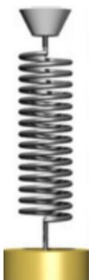
Para llevar a cabo el estudio dinámico del muelle se coloca un número de pesas suficiente para que se alargue el muelle. A continuación, se alarga un poco más el muelle con la mano y se suelta con lo que la masa ligada al muelle empezará a describir un movimiento armónico simple, cuyo período podemos determinar a partir del tiempo  $t$  de  $n$  oscilaciones mediante
