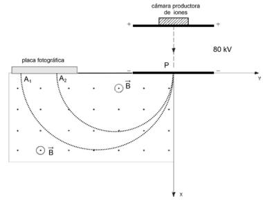
Se pretende identificar dos iones diferentes de dos isotopos de potasio,  $^{39}K^+y$   $^{41}K^+$ , de 39 y 41 u.a.m. respectivamente. Para ello, tras su obtención en la cámara de iones, se aceleran mediante una diferencia de potencial de 80 kV. El haz de iones penetra en un campo magnético de valor B=0.5 T perpendicular a la trayectoria inicial de los iones, que impactan después de una trayectoria semicircular en  $A_1$  y  $A_2$ . Determinar:
