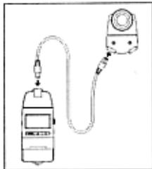
4. Conectar los dos adaptadores con el cable de extensión.
