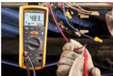
Multímetro con medida de aislamiento **Fluke 1587**
