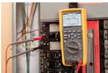
Multímetro **Fluke 289** de verdadero valor eficaz y con funciones de registro
