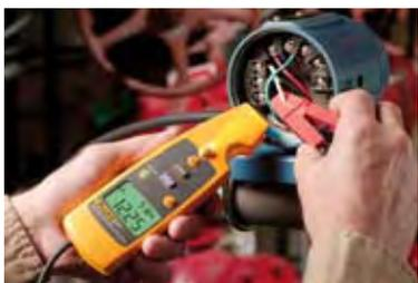
Pinza amperimétrica (mA) para procesos **Fluke 771**
