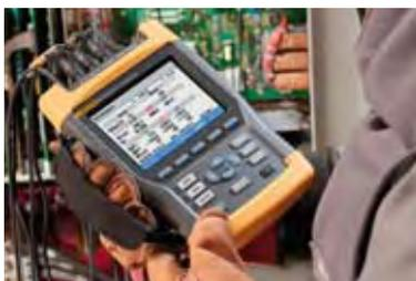
Analizador trifásico de calidad eléctrica **Fluke 435**
