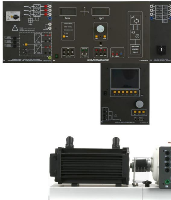
Montaje del experimento (en este caso, con motor de condensador)
