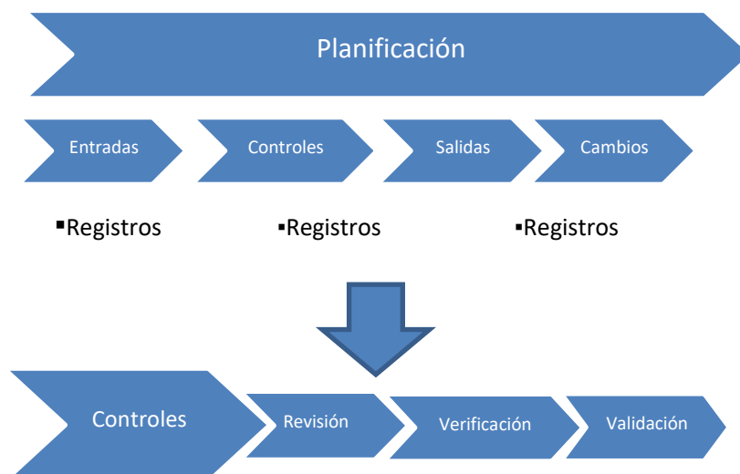
Figura 2: Aspectos a tener en cuenta en la gestión del diseño y desarrollo
