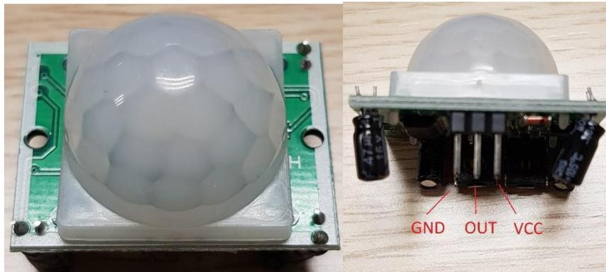
*Ilustración 51. Sensor de movimiento PIR modelo HC-SR501*
