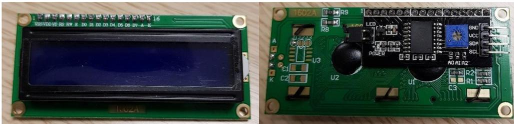
*Ilustración 21. LCD con convertor I2C*
