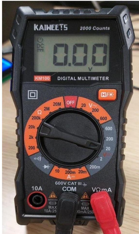
*Ilustración 11. Ejemplo de un multímetro*
