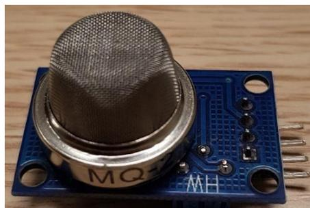
*Ilustración 42. Sensor de gas MQ-2*
