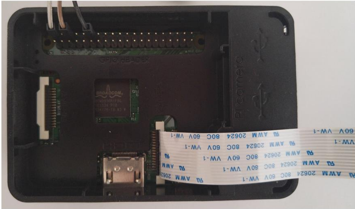
Ilustración A1 1: Conexión sensor PIR y cámara
