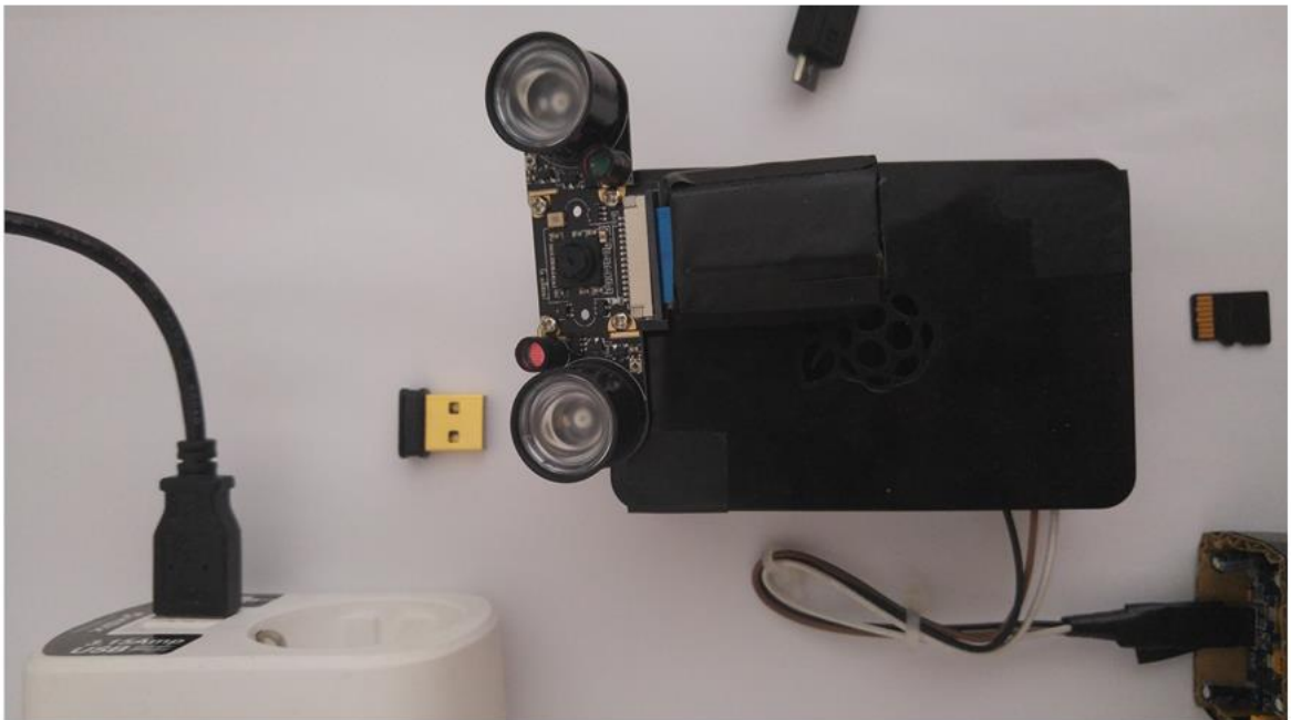
Ilustración A1 3: Conexión de Wifi, SD y alimentación del sistema de la cámara
