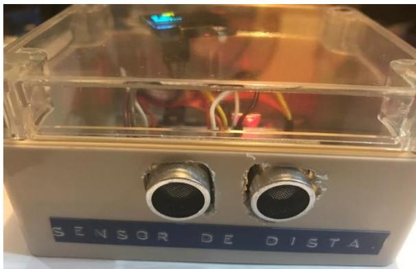
*Figura 41 Prototipo creado para un capturador con sensor de distancia(II)*
