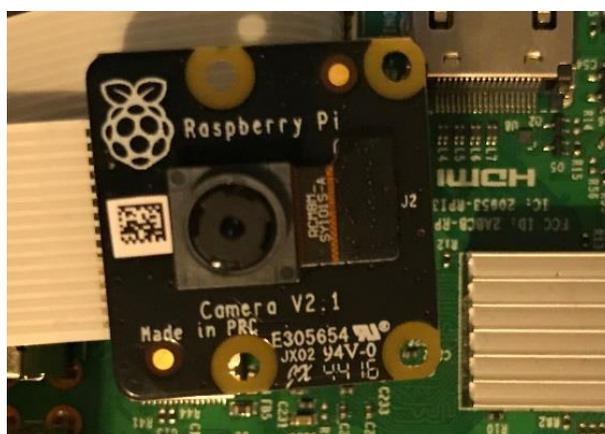
*Figura 28 Cámara para Raspberry Pi, versión 2.1*
