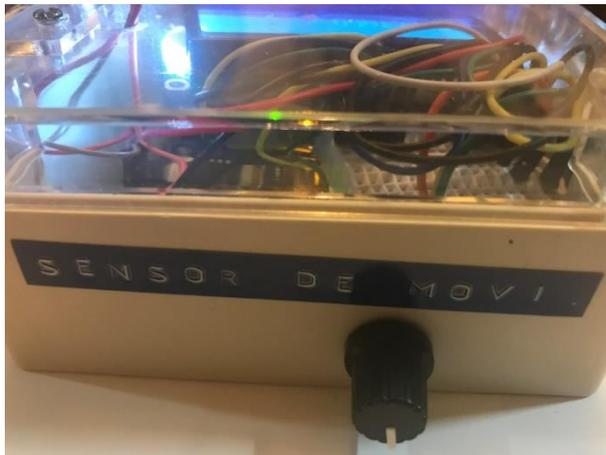
*Figura 39 Prototipo creado para un capturador con sensor de movimiento (II)*
