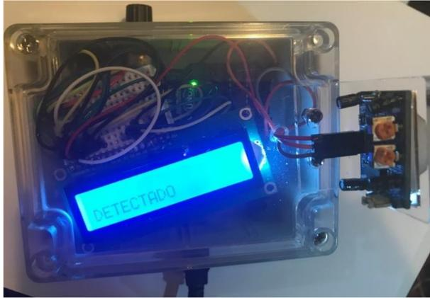
*Figura 38 Prototipo creado para un capturador con sensor de movimiento*
