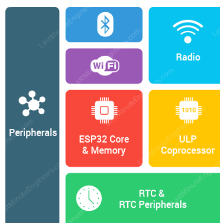
Figura 49: Módulos del chip ESP32 [31].
