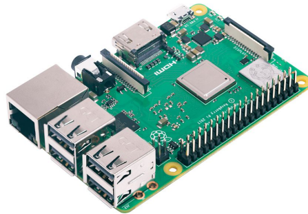
Figura 18: Placa de desarrollo Raspberry Pi 3 Model B+ [48].
