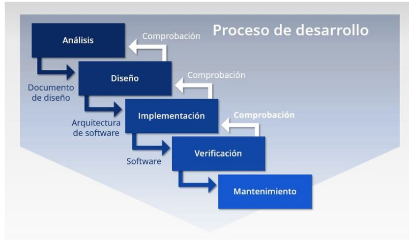
Figura 3: Diagrama del modelo en cascada [19]
