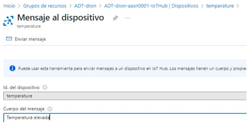
Figura 5.18. Mensaje enviado al dispositivo cliente “temperature”.
