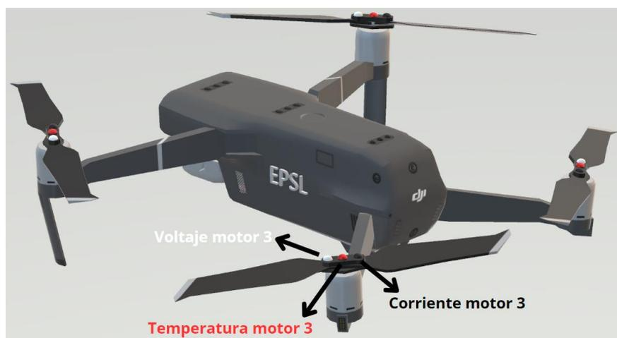
Figura 5.29. Detalle del motor 3 con sus respectivos sensores.
