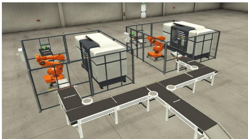
Figura 3.10. DT de una línea de producción realizado con el software *Factory IO*.
