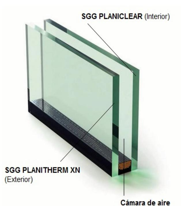
Ilustración 38. Esquema del acristalamiento elegido.
