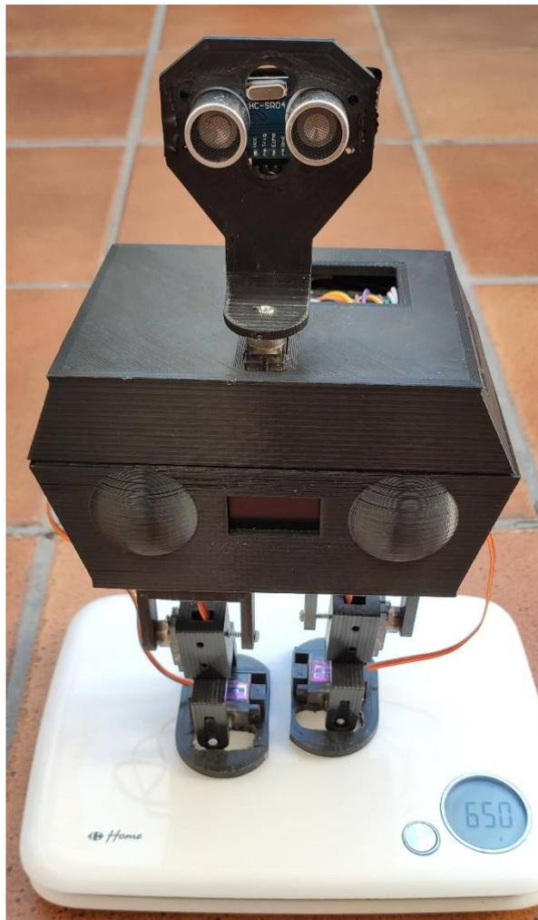
*Ilustración 70. Peso del prototipo*
