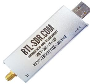
Figura 3.4 Dispositivo RTL-SDR
