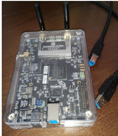
Figura 3.7 Dispositivo bladeRF x40
