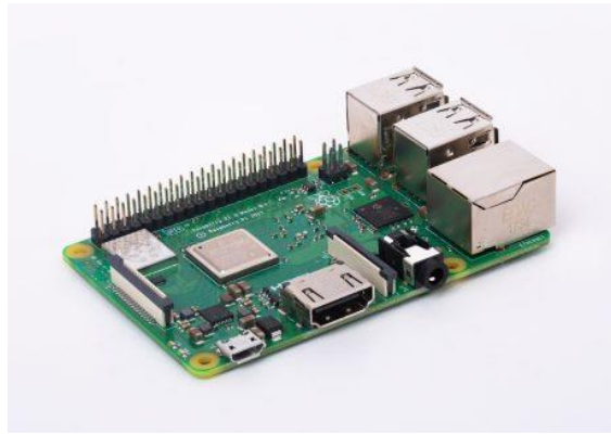
Figura 13: Raspberry Pi 3 Modelo B+ presentado en marzo de este año
