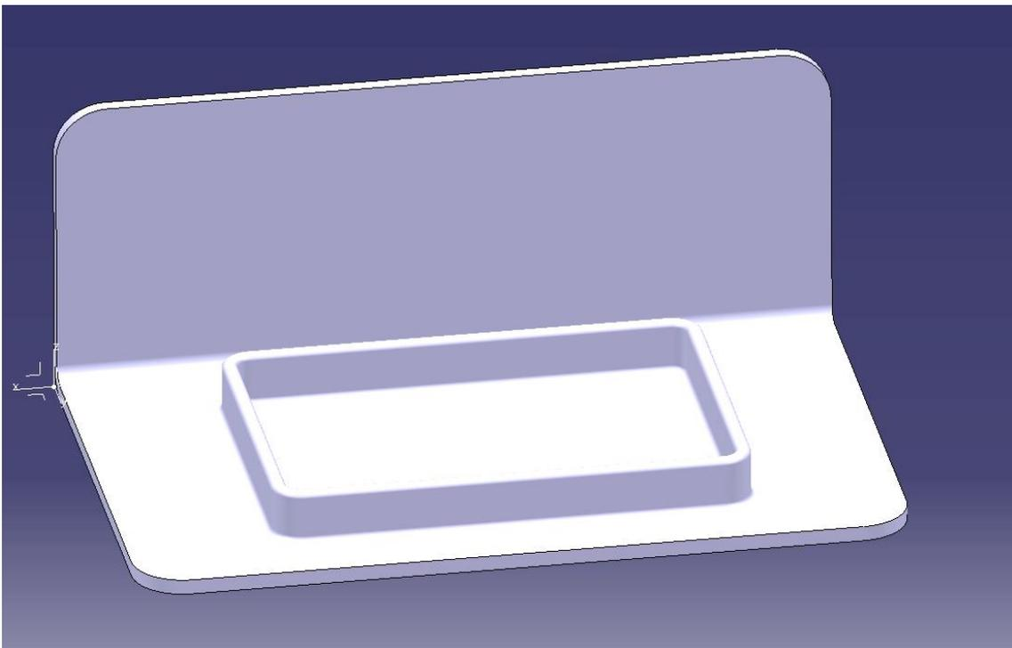
*Figura 8. Modelo 3D diseñado para el posicionamiento del sensor MPU6050.*
