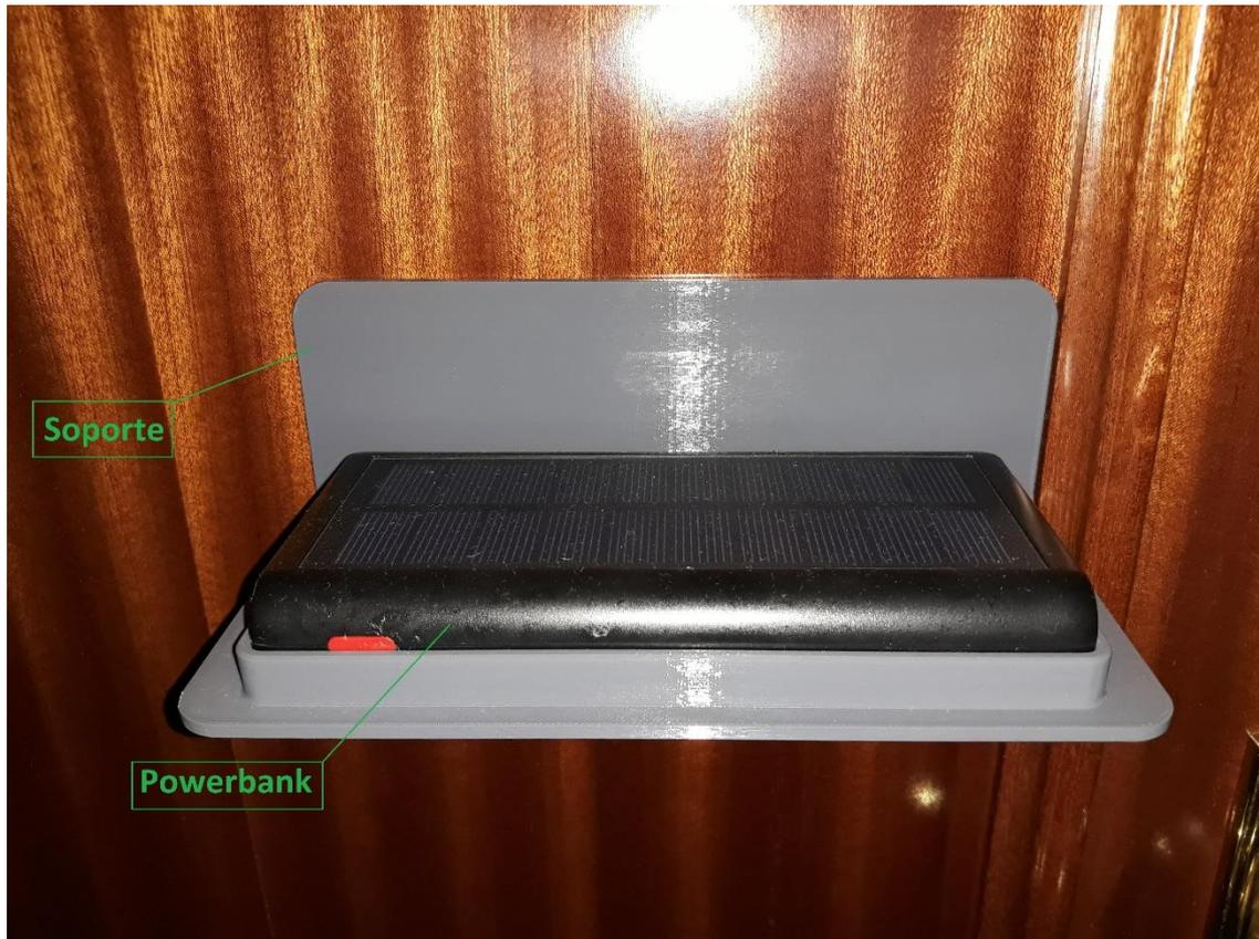
*Figura 6. Soporte diseñado para la colocación de la powerbank.*
