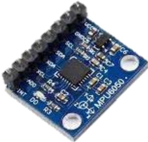
Figura 80. Módulo MPU 6050.
