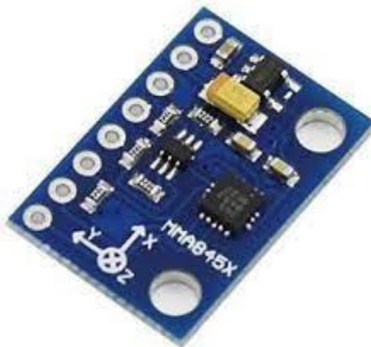
Figura 79. Acelerómetro HW 616.
