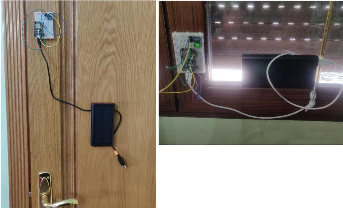
Figura 21. Colocación de la placa y la batería en la puerta y ventana.
