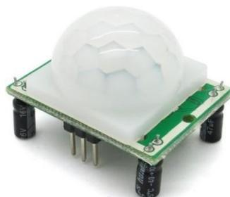
Ilustración 9 Sensor de movimiento HC.SR501 PIR
