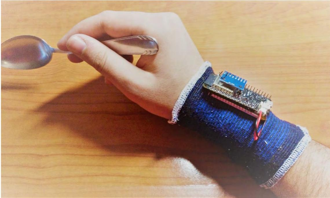
Figura manuales 30.- Uso del sensor de comer
