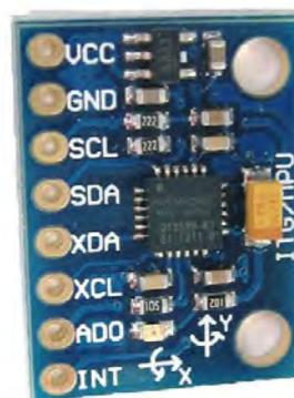
Figura 2.3.-Sensor MPU-6050
