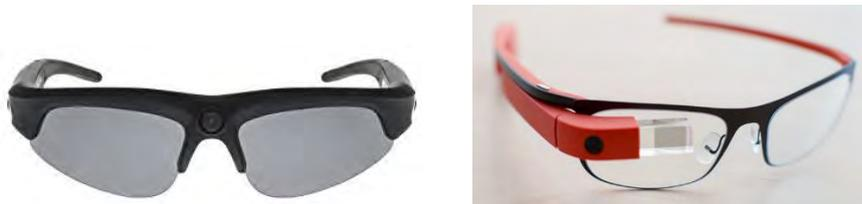
Figura 2. Gafas con dispositivo wearable de visión integrado
